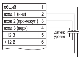
Подключение кондуктометрических датчиков уровня
