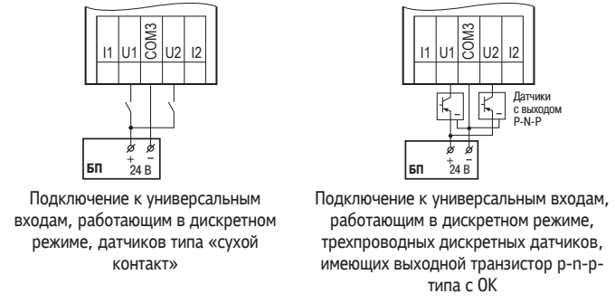
Подключение трехпроводных дискретных датчиков, имеющих выходной транзистор р-п-р-типа с открытым коллектором
